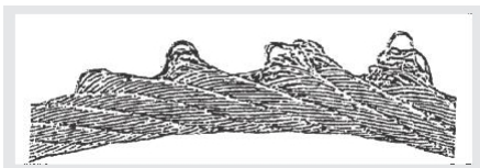
6. ábra: drótkötél kopás és szakadás jeleivel a szálakon.7. ábra: sérült drótkötél: soha ne használjon drótkötelet ilyen állapotban.
